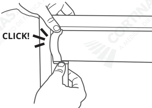
Para colocar el del lado derecho, debemos meter la cadena por el agujero del embellecedor.
